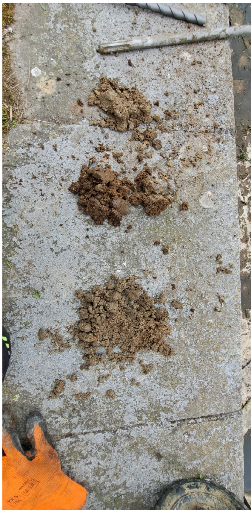
7. Materiál jádrového odvrtu v levobřežní zdi
